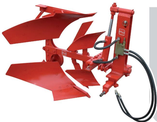
Conçues pour les tracteurs de moyenne puissance, ces charrues sont équipées d'un système de retournement hydraulique. Elles sont parfaitement adaptées pour les labours des professionnels.
